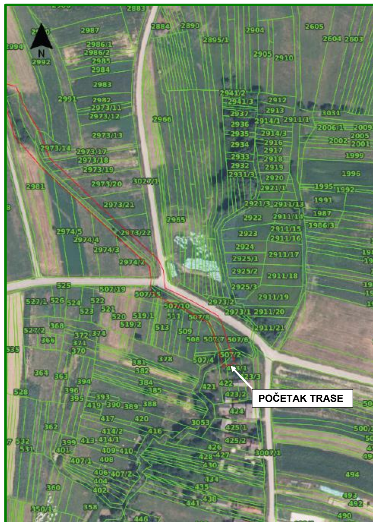
Slika 24. Prikaz početka potoka u odnosu na katastarske čestice, Mjerilo: 1:2000 (Izvor: Informacijski sustav prostornog uređenja , crvenom bojom je označen potok)
