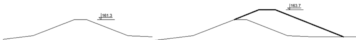
Sl. 2.1.1 Povišenje kote krune brane varijantnog rješenja 2 i 3
